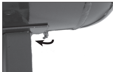
Figura 10 - Drenaje manual del tanque
